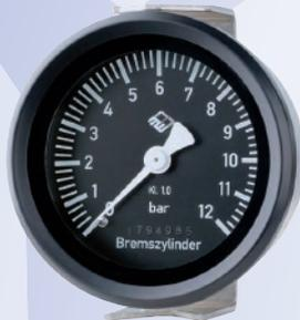
**Doppel-Manometer** dienen zum gleichzeitigen Ablesen zweier Drücke, z.B. an den Bremszylindern von zwei Drehgestellen oder an der Hauptluftbehälterleitung und der Hauptluftleitung einer Druckluftbremsanlage.
